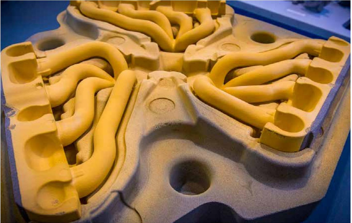
Abb. 1: Beispiel eines Kernpakets für die Herstellung von Abgaskrümmern.
