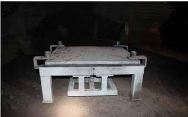
Abb. 22: Sandwich-Sicherheitsstruktur nach dem Explosionstest.
