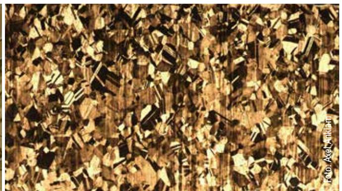
Mikroskopische Aufnahme eines austenitischen Gefüges (Cr-Ni-Stahl)
