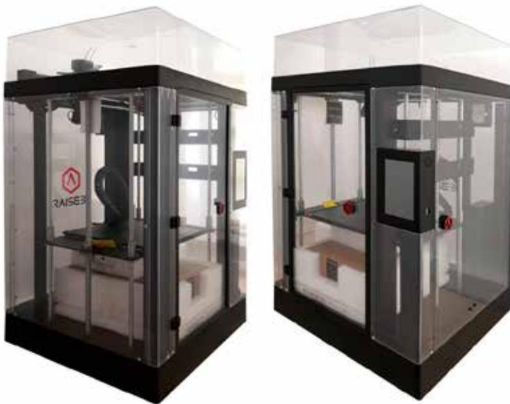
Abbildung 2: Mehr-Komponenten-3D-Drucker für die Herstellung erster Funktionsmuster im Rahmen studentischer Arbeiten und für Ansichtsmodelle komplexer mechanischer Aufbauten
