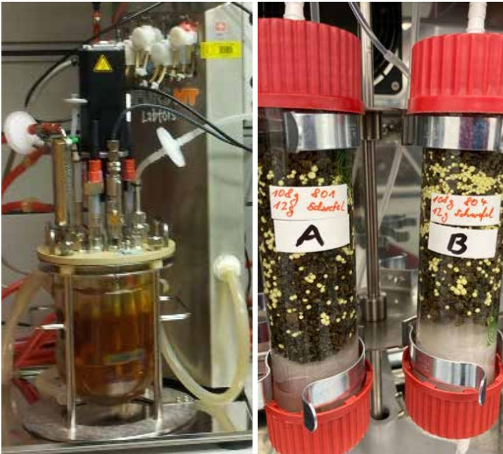
Abb. 3: Rührtankreaktor (links) und Säulen (rechts) zur Biooxidation von Platinerzen in den Laboren des Instituts für Biowissenschaften der TU Bergakademie Freiberg.
