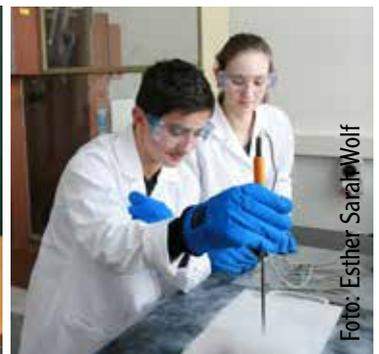
Abkühlen der Proben in flüssigem Stickstoff beim Kerbschlagbiegeversuch
