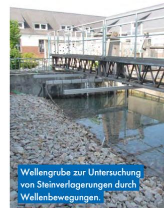
Wellengrube zur Untersuchung von Steinverlagerungen durch Wellenbewegungen.
