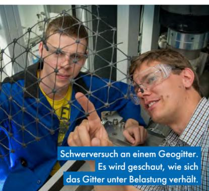
Schwerversuch an einem Geogitter. Es wird geschaut, wie sich das Gitter unter Belastung verhält.
