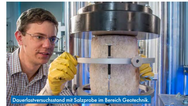
Dauerlastversuchsstand mit Salzprobe im Bereich Geotechnik.
