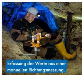
Erfassung der Werte aus einer manuellen Richtungsmessung.
