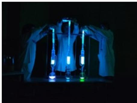
Abb. 2: "Kalttes Licht" in einer Glasapparatur (Mitte: blau - ohne Zusätze; links: violett - mit Rhodamin B; rechts gelb-grün - mit Fluorescein).
