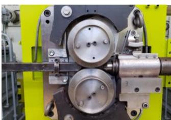
Anschließend an das Vorgerüst folgen vier drei nachfolgenden Walzgerüste in Konti-Anordnung und einer Kühlstrecke. Die Anordnung erfolgt dabei in H-V-H-V. Abschließend kann der fertige Draht eine Kühlstrecke mit anschließende Ofen durchlaufen. Außerdem existiert ein Stelmor-Abkühlstrecke inklusive Windungsleger für eine industriennahe Prozessführung.
